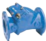
Serie 41/60 Rückschlagklappe mit freiem Wellenende weichdichtend Gehäuse aus Duktalguss (GJS) mit Epoxy- Beschichtung DN 50-300
