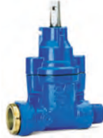
Serie 03/85 Hausanschluss-Schieber mit konischem Außengewinde / zugfeste Schraubkupplung für PE-Druckrohre DN 25-32 PN 16 Duktilguss
