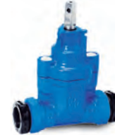
Serie 03/90 Hausanschluss-Schieber mit PRK-Kupplungen für PE Druckrohr DN 20-50 PN 16 Duktilguss
