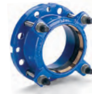
Serie 623/10 Supa-Plus™ Flanschadapter zugfeste Dichtung für PE-PVC-Rohre Duktilguss PN 16/10 DN 40-300
