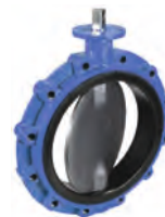
Serie 75/31 Zentrische Absperrklappe mit aufvulkanisierter Manschette Zwischenflansch- ausführung Duktilguss (GJS) mit Epoxy-Beschichtung DN 50-300 Alle Antriebsarten möglich
