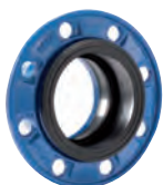
Serie 05 Kombiflansch für PVC- und PE-Druckrohre GJS PN 10 oder 16 nicht zugfest DN 50 - 300
