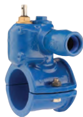
Serie 10/9, SVK-ST Anbohrarmaturen mit Betriebsabsper- rung PVC-Druckrohr Schwenkventil-Schelle nach DIN 3543 Innen Email, außen EKB Typ SVK-ST DN 80-300, PN 16
