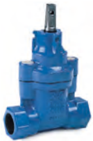
Serie 03/00 Hausanschluss-Schieber mit Innengewinde BSP DN 25-50 PN 16 Duktilguss
