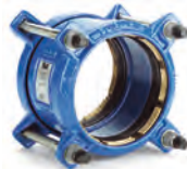
Serie 621/10 Supa-Plus™ Rohrkupplung zugfeste Dichtung für PE-PVC-Rohre Duktilguss PN 16 DN 32-300
