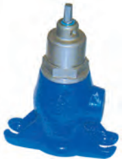
Serie 10/9, MMG Anbohrarmaturen mit Betriebsabsper- rung und integriertem Bohrer für Gussrohr nach DIN 3543 Innen Email, außen EKB Typ MMG DN 80-300 PN 16
