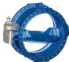
Serie 756/102 Doppelexzentrische Absperrklappe Edelstahl-Sitzring mit AUMA- Flanschgetriebe DN 200-2800 PN 10/16 Duktilguss Option: integrierte Dichtfläche • PN 25 in DN 200-1200
