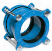
Serie 601 Supa™ Rohrkupplung DN 40-400 Gas: PN 7 Wasser: PN 16 Duktilguss
