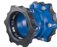
Serie 632 Supa Maxi™ universale zugfeste Reduzierkupplung DN 50-300 PN 16 Duktilguss
