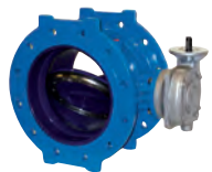
Serie 756/1 Doppelexzentrische Absperrklappe integrierte Dichtfläche mit AUMA- Flanschgetriebe DN 200-2800 PN 10/16 Duktilguss Option: • innen Email (bis DN 600) • PN 25 in DN 200-1200
