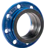
Serie 05 Kombiflansch für Duktilgussrohr GJS PN 10 oder 16 nicht zugfest DN 50 - 300
