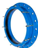
Serie 260 Flansch-Rohrkupplung für AZ, Stahl, Grauguss und Duktilguss-Rohr Stahl DN 350-2000 PN 10/16/25
