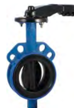
Serie 820/00 Zentrische Absperrklappe mit auswechselbarer Manschette Einklemmausführung Duktilguss (GJS) mit Epoxy-Beschichtung DN 25-1000 Alle Antriebsarten möglich
