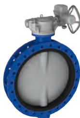
Serie 820/20 Zentrische Absperrklappe mit auswechselbarer Manschette Doppelflanschausführung Duktilguss (GJS) mit Epoxy-Beschichtung DN 150-1.600 Alle Antriebsarten möglich
