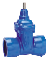
Serie 33/00 Absperrschieber mit Steckmuffen für Gussrohr DN 80-300 PN 16 Duktilguss Innen Email
