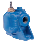
Serie 10/9, SV-G Anbohrarmaturen mit Betriebsabsper- rung für Guss-, Stahl- und AZ-Rohre nach DIN 3543 Innen Email, außen EKB TYP SV-G DN 80-300 PN 16
