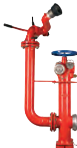
Serie 27 Überflurhydrant "modern" Einbautiefe 2' bis 6' (60,96 cm - 182,88 cm) DN 100/150, PN 17,2 UL/ULC registriert (DN 150) FM Zulassung (DN 150)
