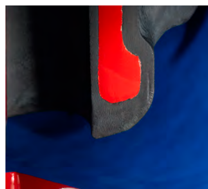
Beim erneuten Öffnen kehrt der Elastomer in seine Originalform zurück.
