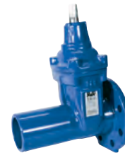
Serie 12/50 Tauschschieber Eine Seite mit Festflansch eine Seite mit Spitzende u. zugfestem Sparflansch DN 50-300 PN 10 Duktilguss EKB RAL 5017
