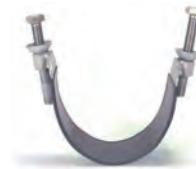
Serie 10/9 Bügel Flexibler Edelstahl-Bügel für Guss-, Stahl- und AZ-Rohre Gummi-ummantelt inkl. Dichtungen, Kalotten und Schrauben Verwendbar für Typ MMG, SV-ST und SV-G
