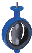
Serie 75/10 Zentrische Absperrklappe mit aufvulkanisierter Manschette Einklemmausführung Duktilguss (GJS) mit Epoxy-Beschichtung DN 40-1400 Alle Antriebsarten möglich
