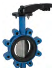
Serie 820/10 Zentrische Absperrklappe mit auswechselbarer Manschette Anflanschausführung Duktilguss (GJS) mit Epoxy-Beschichtung DN 25-600 Alle Antriebsarten möglich
