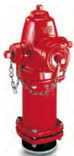
Serie 27 Überflurhydrant "modern" Einbautiefe 2' bis 6' (60,96 cm - 182,88 cm) DN 100/150, PN 17,2 UL/ULC registriert (DN 150) FM Zulassung (DN 150)
