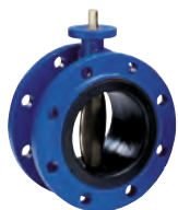
Serie 75/20 Zentrische Absperrklappe mit aufvulkanisierter Manschette Doppelflansch kurz Duktilguss (GJS) mit Epoxy-Beschichtung DN 50-2000 Alle Antriebsarten möglich
