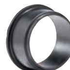
Serie 05 Dichtring für Kombiflansch uPVC, Stahl- oder Duktilguss-Rohr nicht zugfest SBR DN 400-600 (uPVC und Duktilguss) DN 50-300 (Stahl)
