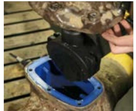
Das Foto oben zeigt ein voll funktionsfähiges PUR-beschichtetes AVK-Ventil aus dem Jahr 1989, das nach 21 Jahren Betrieb ausgegraben wurde. Das Ventil musste wegen der Robustheit der Beschichtung mit einem Winkelschleifer geöffnet werden, und das Ventil war noch immer in einwandfreiem Zustand.
