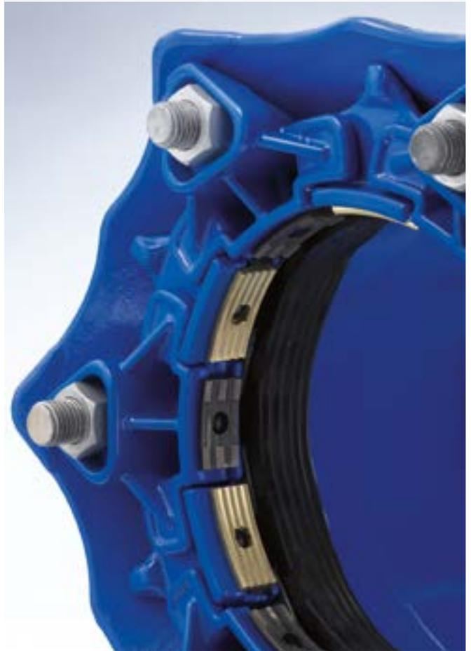
Große Toleranzen bei den Einstecktiefen ermöglichen das Verwenden von leicht schräg geschnittenen Rohren, ohne dass sich das Rohr beim Anziehen der Schrauben nach innen verschiebt. Dadurch wird eine unkomplizierte Montage ohne präzises, zeitaufwendiges Anpassen der Rohre gewährleistet.
